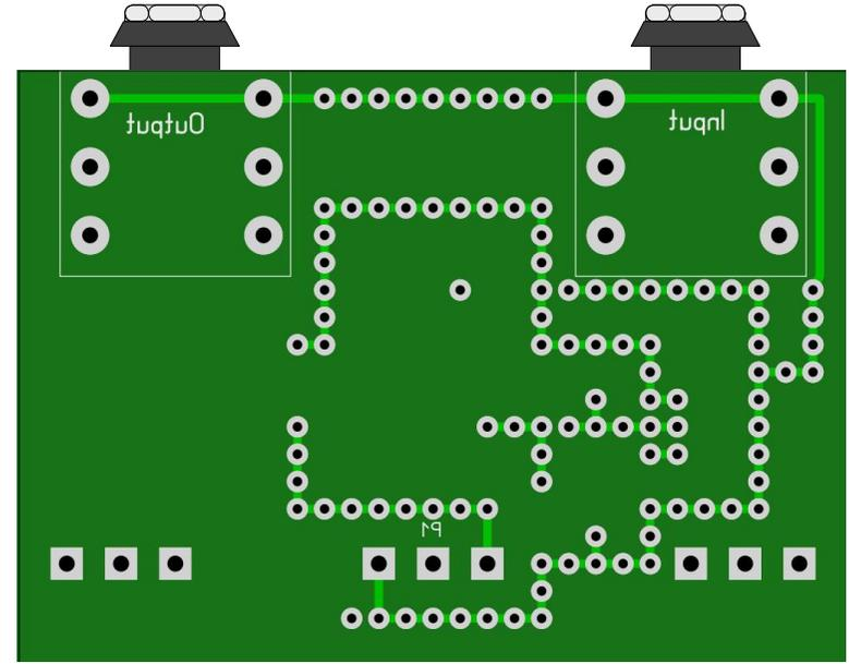
Potentiometer auf Lötseite positionieren!
